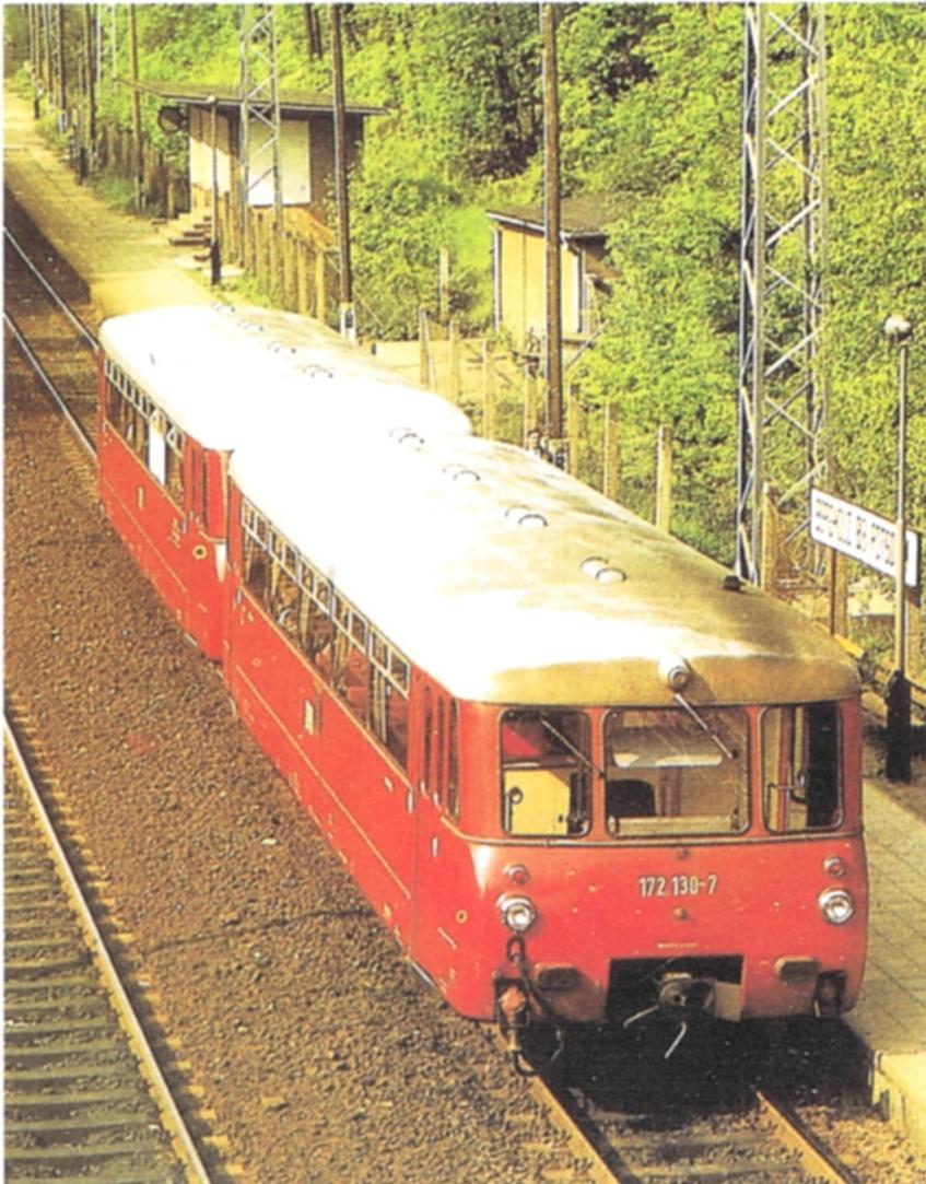
Schon immer hat es bei der Bahn Neben- und Zubringerstrecken gegeben. Sie haben typischerweise nur ein bescheidenes Fahrgastaufkommen. Der Einsatz lokbespannter, längerer Züge ist hier nicht lohnend. Kleinere Einheiten werden benötigt. Ein einzelner Triebwagen ist oft ausreichend, im Bedarfsfall ergänzt durch einen Steuerwagen und eventuell einen Mittelwagen. Die Betriebe der DWA haben schon in früheren Jahren solche Fahrzeuge gebaut.
