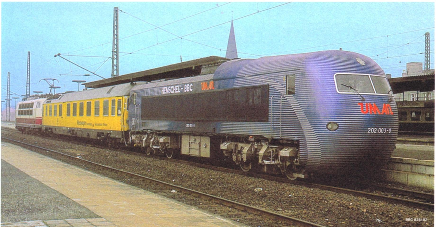
2. Lediglich durch Umkopplung der Masse des Antriebssystems vom Drehgestellrahmen auf den Fahrzeugrahmen ließ sich die Strecken-Höchstgeschwindigkeit von 250 km/h fahren.
