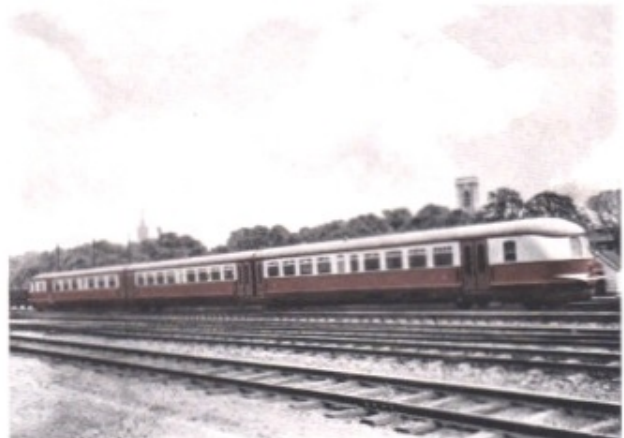
Nebenscheid. Belgien : Dreiteiliger 1200 PS diesel-hydraulischer Schnelltriebwagen
