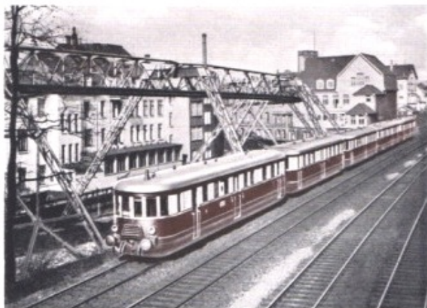
Deutschland: Zusammengekuppelte 400 PS - Hauptbahntriebwagen mit elektrischer Kraftübertragung
