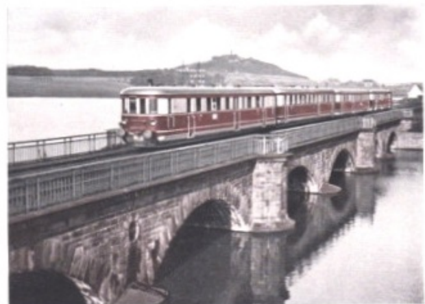
Deutschland : 400 PS diesel-elektrische Hauptbahn-Triebwagen mit Steuerwagen
