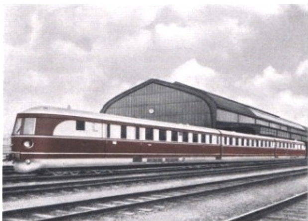
Deutschland: Dreiteiliger diesel-hydraulischer 1200 PS-Schnelltriebwagen
