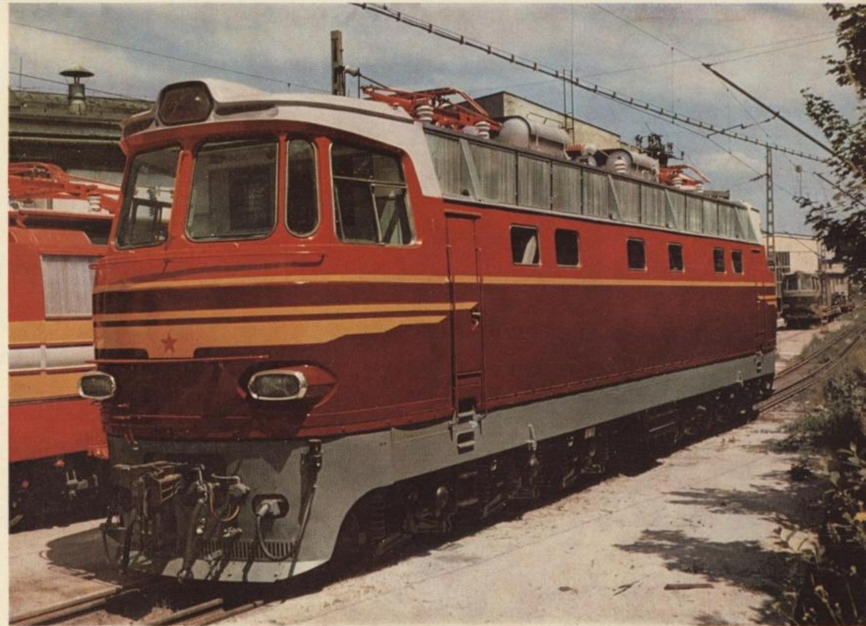
Cette locomotive est destinée pour le remorquage des trains rapides du poids total de 1000 tonnes sur les lignes de la U. R. S. S. électrifiées avec 25 kV — 50 Hz. Avec une puissance de 5100 kW, qu'on peut utiliser dans toute l'étendue de vitesses, la locomotive 52 E se place parmi les locomotives d'express les plus puissantes du monde.
