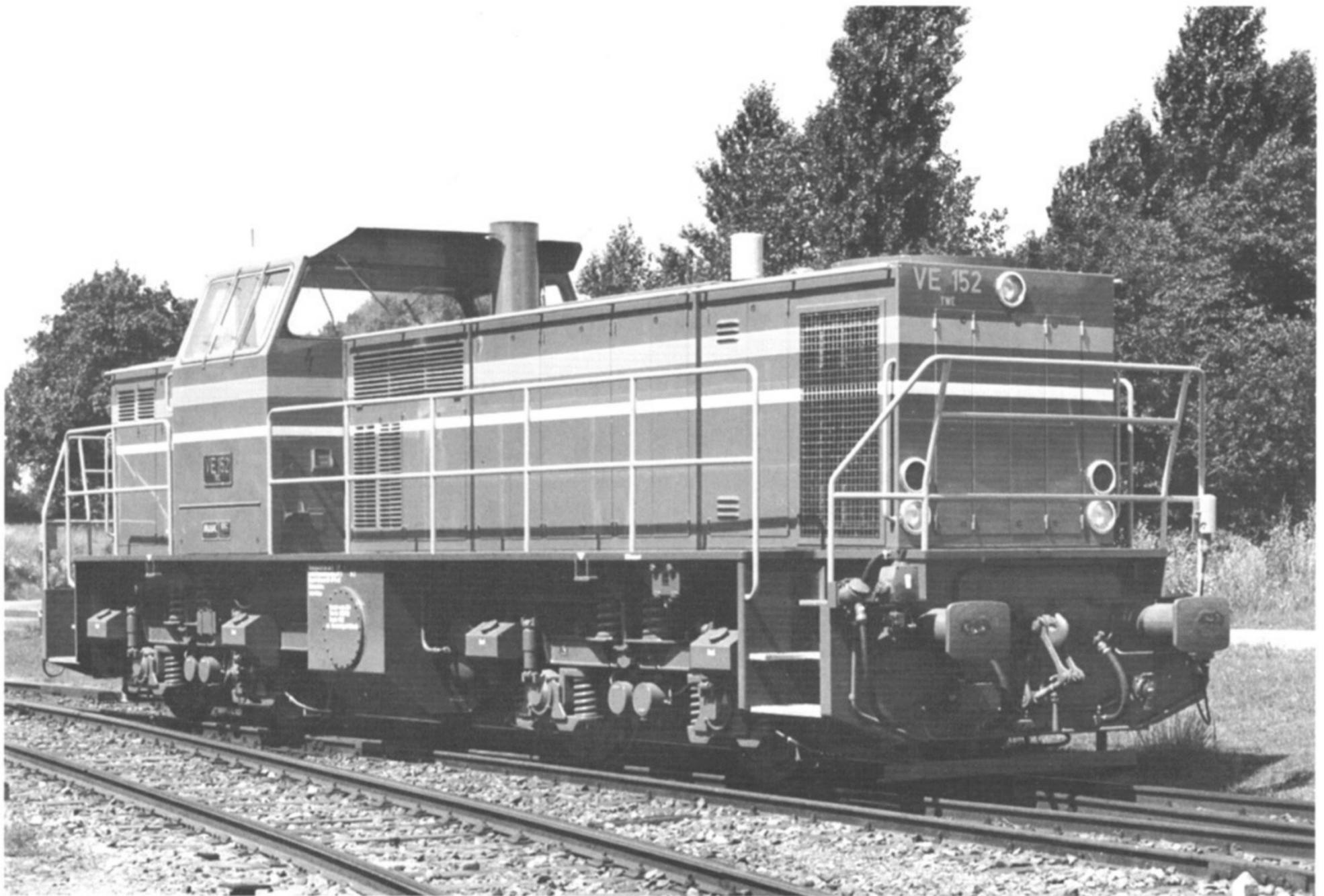
Dieselektrische Standardlokomotive Typ DE 1002 mit Drehstrom-Leistungsübertragung
