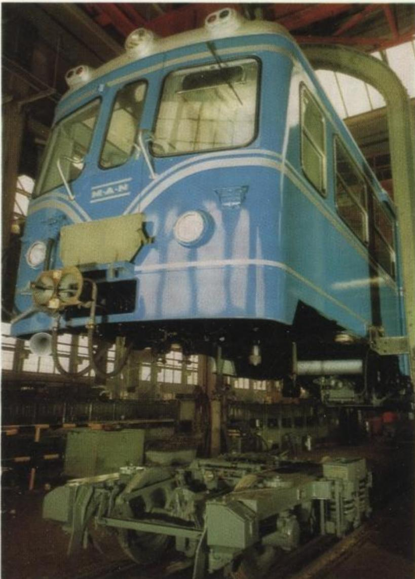
Der Wagenkasten wird auf die Drehgestelle gesetzt.
