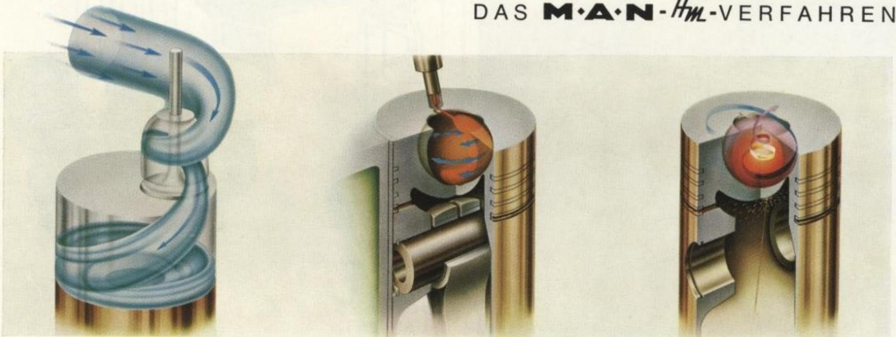
Erzeugung einer kreisenden Luftströmung im Zylinder beim Ansaughub durch besondere Formgebung des Einlaßkanals (Drallkanal)
