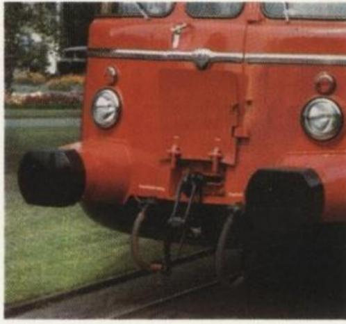
Zug- und Stoßvorrichtung mit Seitenpuffern und Schraubekupplung.
