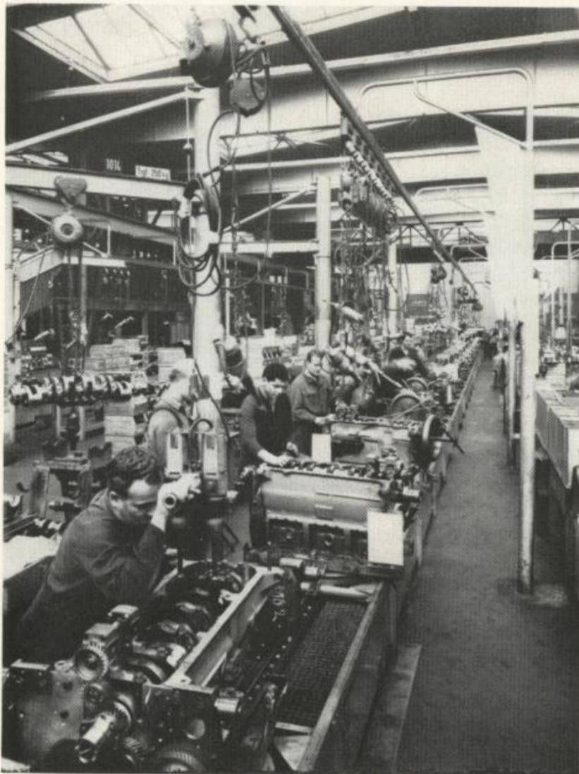
Die Motoren für die leichten Dieseltriebwagen werden im Werk Nürnberg der M.A.N. am Fließband gefertigt. Der Motortyp D 2156 HMUS ist ein Saugmotor, er arbeitet also ohne Aufladung und ist deshalb für den harten Einsatz in Schienenfahrzeugen besonders geeignet, da die zusätzlichen hochtourigen Aufladegeräte entfallen. Nach dem HM-Verfahren arbeitende Motoren weisen einen klopfreien Lauf in allen Belastungszuständen auf und zeichnen sich durch geringen Kraftstoffverbrauch aus.
