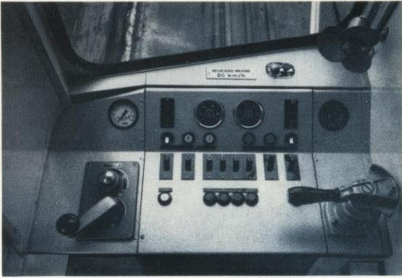
Im Führerstand sind alle Instrumente und Bedienungsorgane übersichtlich und griffgünstig angeordnet. Durch die Verwendung von vollautomatischen, hydro-mechanischen Kraftübertragungen, die kein Kuppeln und Schalten während der Fahrt erfordern, kann der Triebwagenführer seine ganze Aufmerksamkeit der Strecke widmen.
