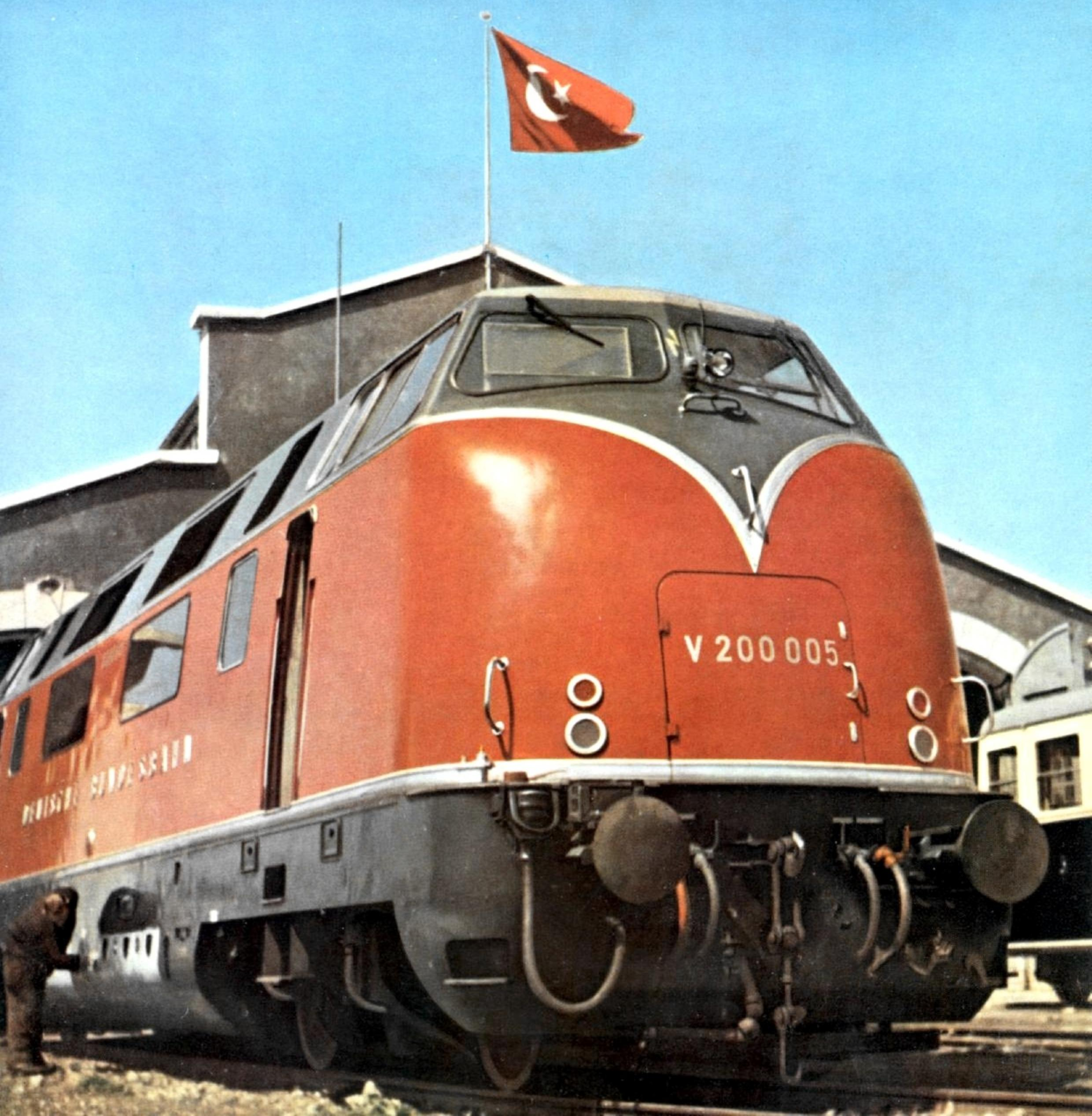
**Die Krauss-Maffei dieselhydraulische 2000 PS-Lokomotive, Bauart V200,**
