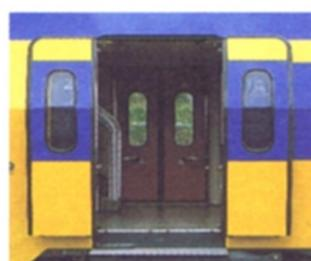
**Einstieg leichtgemacht. Aufstieg auch.** Wie kann der IRM zur pünktlichen Abfahrt und Ankunft der Züge beitragen? Ganz einfach: durch 1300 mm breite Türen und großzügige Eingangsräume – und damit durch schnellere Fahrgastwechsel. Der Boden des Einstiegsraumes liegt 1160 mm
