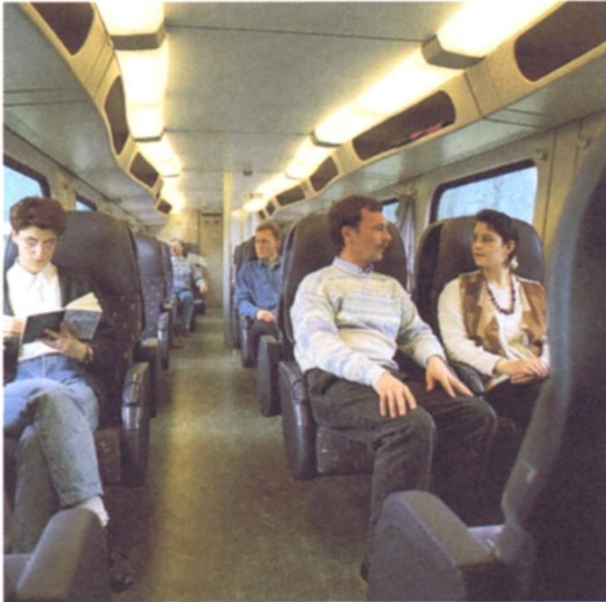
So sieht die erste Klasse im IRM aus. Bequeme, breite und ergonomisch geformte Sitze sorgen für eine angenehme Reise. Die Beleuchtung besteht aus links und rechts vom Gang angeordneten Lichtbändern. Gepäckablagen befinden sich zum einen über den Sitzen, zum anderen zwischen den Rückenteilen der Sitze.
