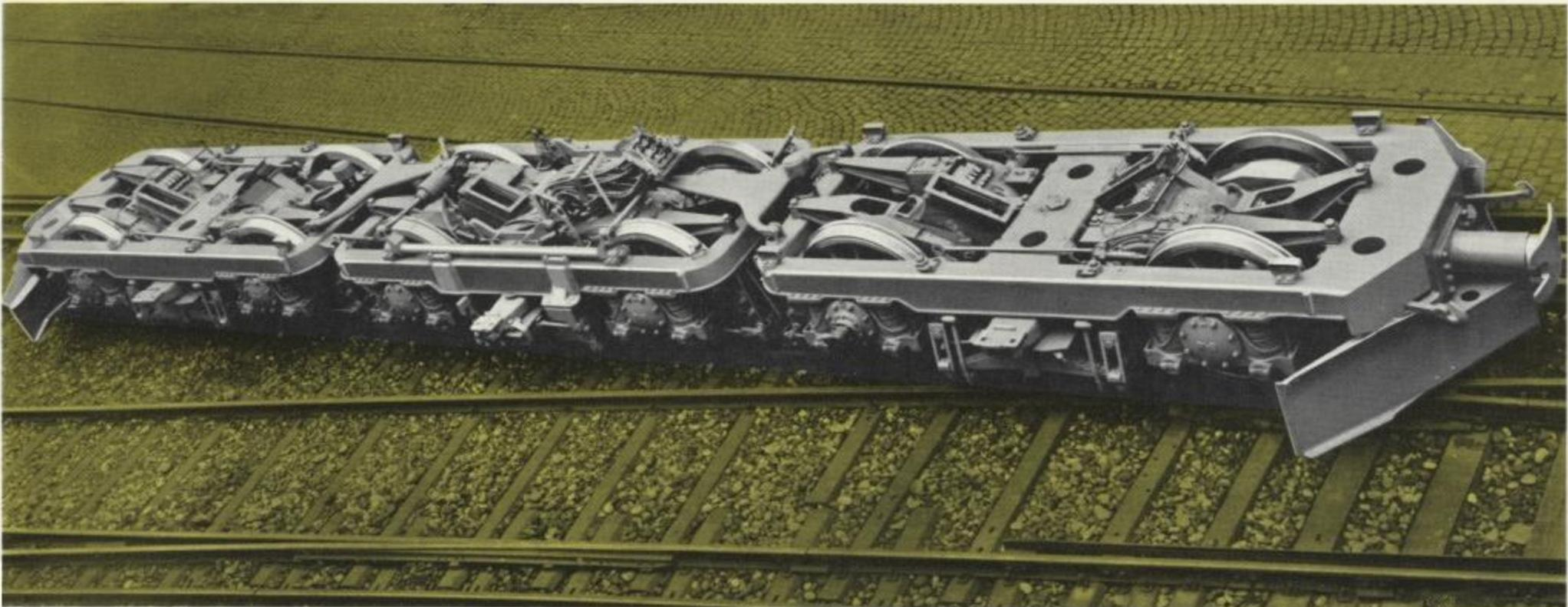
Das interessanteste Triebfahrzeug der Rhätischen Bahn ist die meterspurige Lokomotive der Achsfolge BoBoBo. Die eine Stundenleistung von 2400 PS entwickelnde Maschine befördert auf der kurvenreichen Albulastrecke mit 35‰ Steigung eine Anhängelast von
