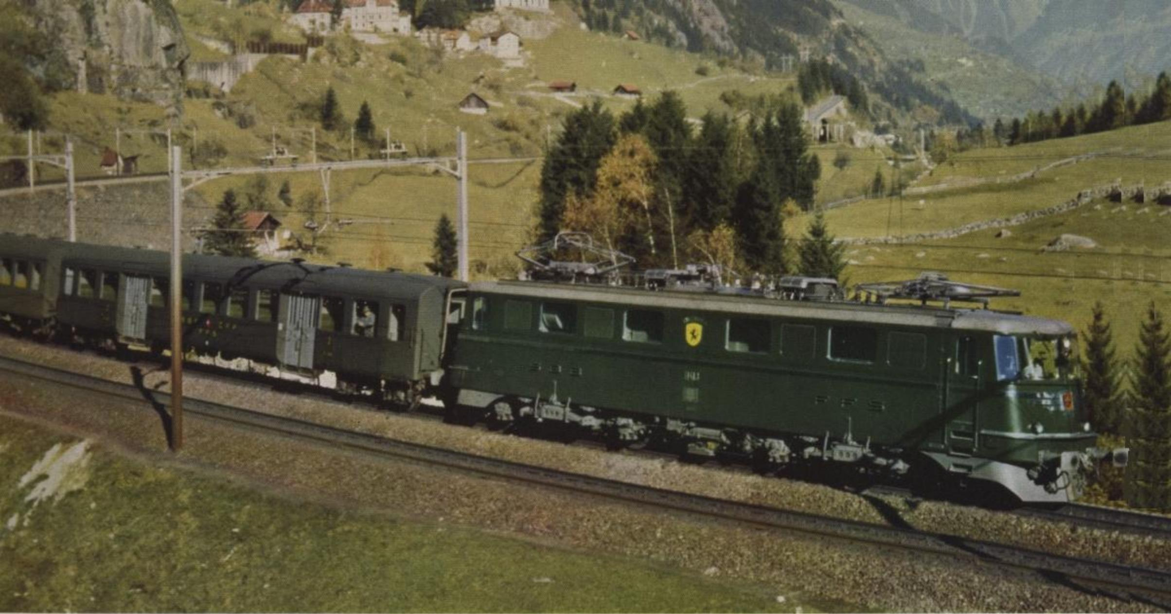
**Einphasen-Wechselstrom-Lokomotive, Achsfolge CoCo, Serie Ae 6/6**
