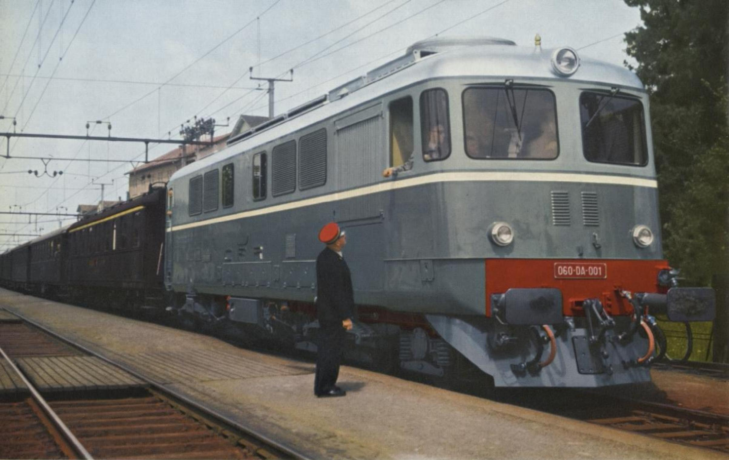
**2100 PS Diesel-elektrische Lokomotive, Achsfolge CoCo**
