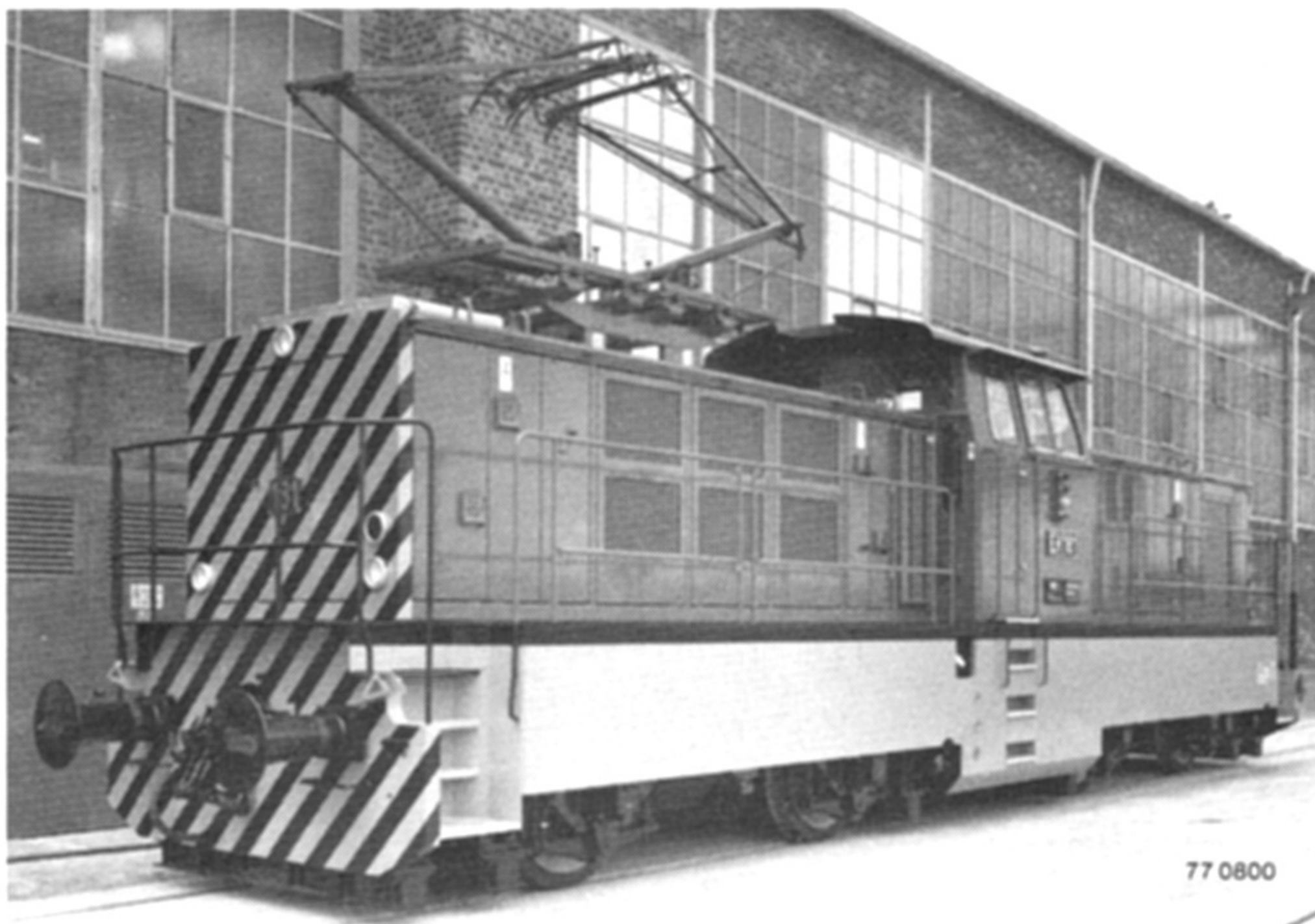
Bild 2: Elektrische Seite der Zweikraftlokomotive EDE 1000/500
