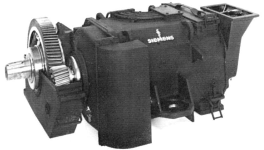
Bild 6. Fahrmotor mit Getriebe.
